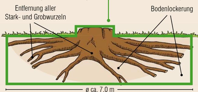
Ein optimales Rodungsergebnis wird erst durch die Entfernung aller relevanten Wurzeln erreicht.
